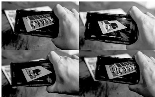
Ilustracja 2: Interaktywna prezentacja modelu architektonicznego za pośrednictwem autorskiej aplikacji wykorzystującej technologię rozszerzonej rzeczywistości [4.1]
